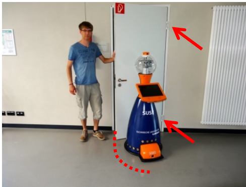
Szenario: Türöffnung einer „Außentür“ - Selbstblockade
